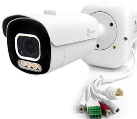
Рис.2. Внешний вид камеры «Сокол-OZ 4Мр Extreme Vision АйТек ППО» с модулем видеоналитики «Детектор дыма и огня»
