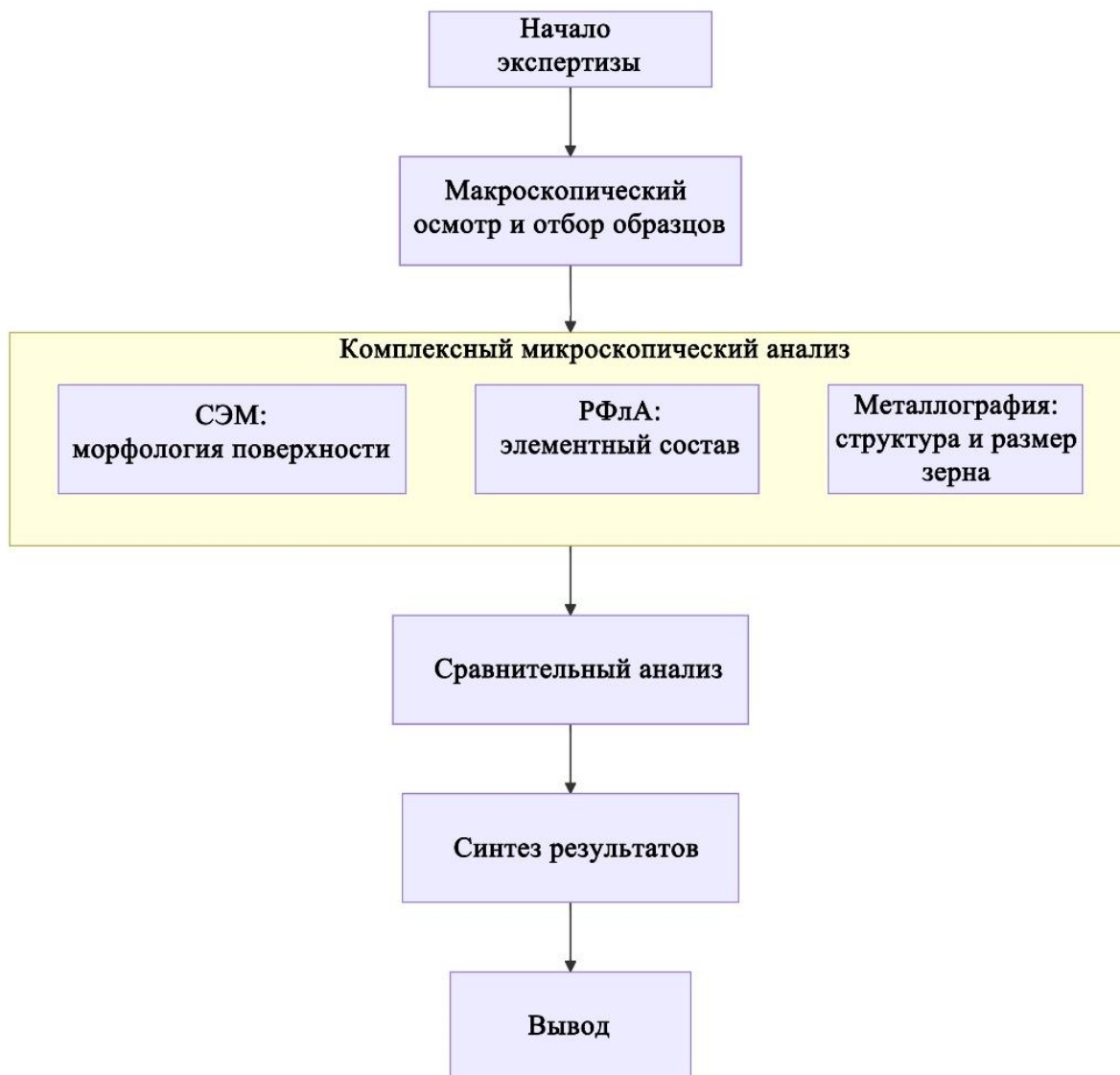
Рис.4. Блок-схема комплексной методики экспертного исследования поврежденных алюминиевых проводов и кабелей
