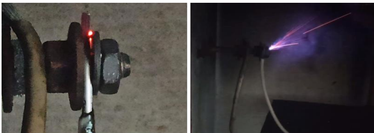
Рис.2. Эксперимент по прохождению по образцу большого переходного сопротивления
