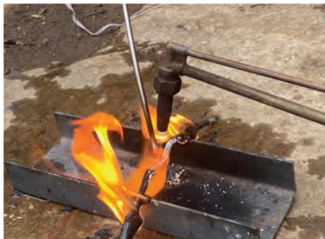
Рис.3. Эксперимент по имитации условий внешнего теплового воздействия пожара
