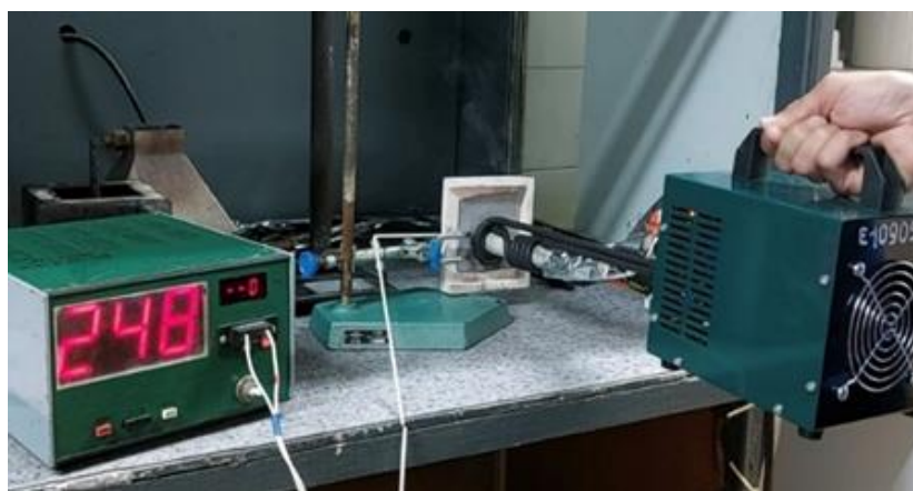
Рис.1. Портативное устройство для определения коэффициента вспучивания
