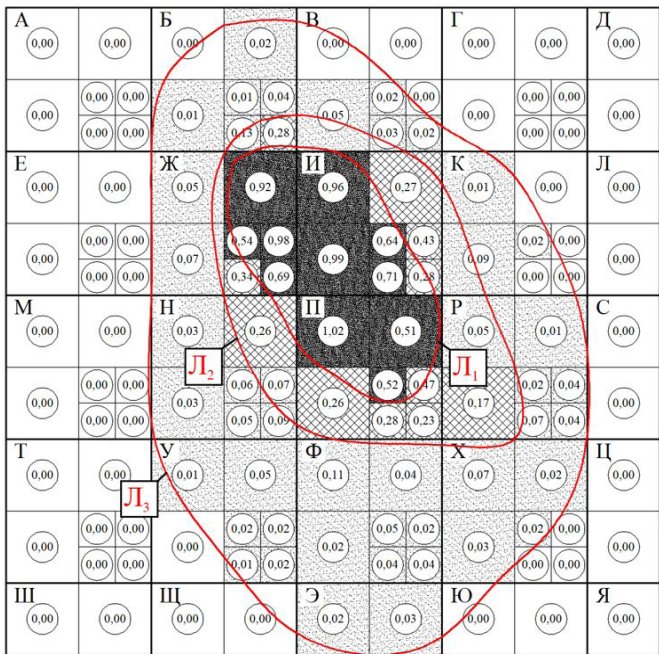
Рис. 5. Распределение общей массы порошка в контрольных точках поперечного сечения газопорошкового потока (на примере: масса навески m = 150 г; расстояние от модели огнетушителя L = 50 см, давление P = 0,7 МПа).
