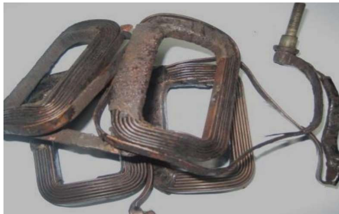
Рис. 8. Оплавление обмотки ротора
