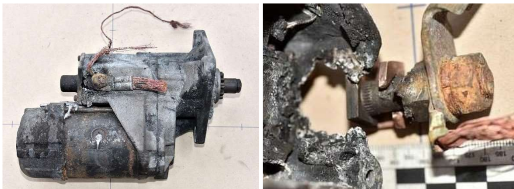
Рис.6. Последствия выхода из строя пускового реле - локальные термические повреждения корпуса (слева) и локальный нагрев контакта к вытягивающему реле (справа)
