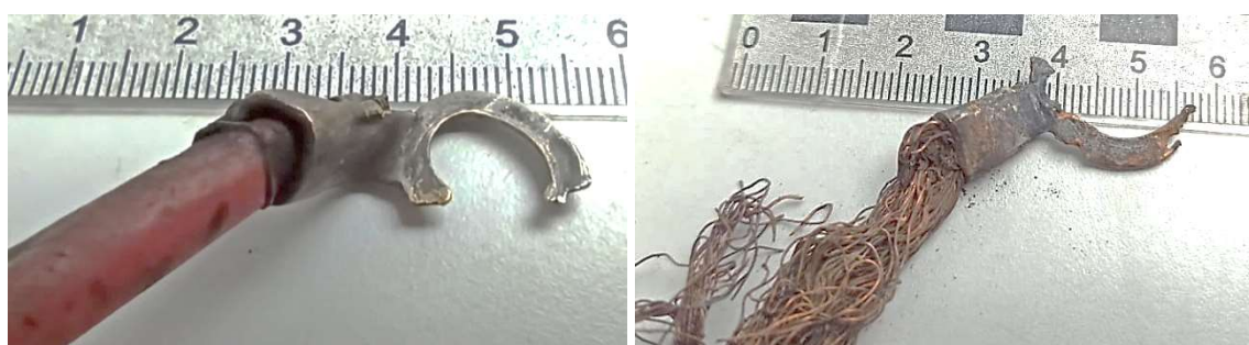
Рис.5. Локальные повреждения клемм, присоединяемых к стартеру
