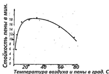
Рис. 1. Влияние температуры воздуха пены на ее стойкость
